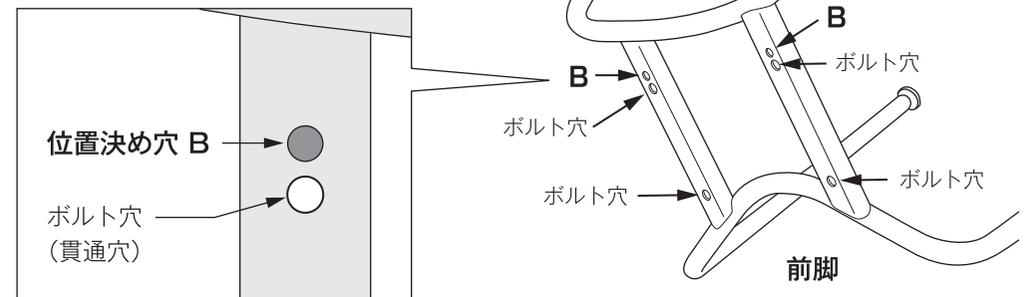
※必ず【位置決め突起 A】を【位置決め穴 B】に挿入して、取り付けてください。
