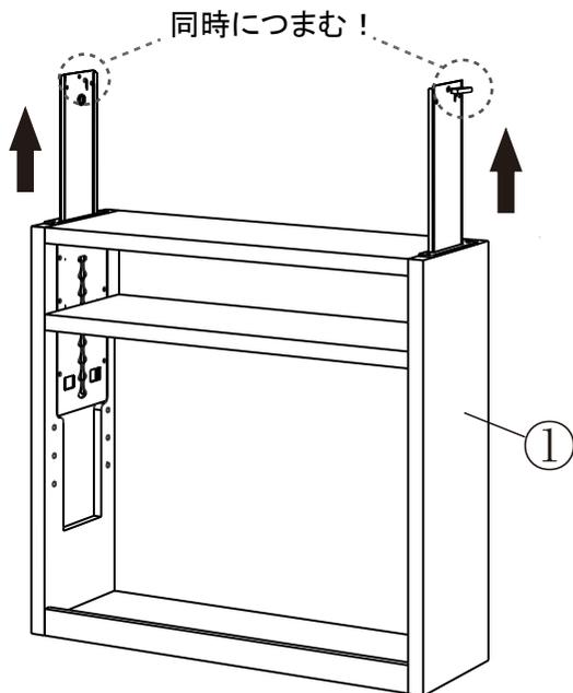
※昇降バーは構造上、左右同時でないと動かないようになっています。故障の原因になりますので、**必ず左右同時に**昇降するようにして下さい。
