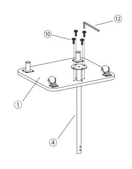
4 下支柱に、⑥ ジョイントパーツを差し込み 穴位置を合わし、⑩ ボルトと⑫ 六角レンチで 取り付ける。
