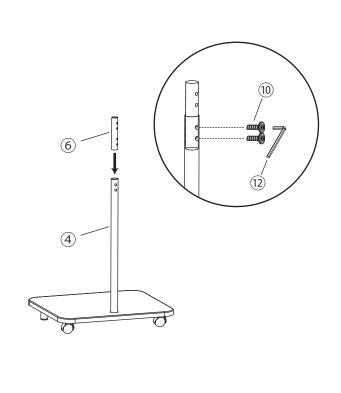
4 ③ 中支柱を、⑥ ジョイントパーツに差し込み 穴位置を合わし、⑩ ボルトと⑫ 六角レンチで 取り付ける。
