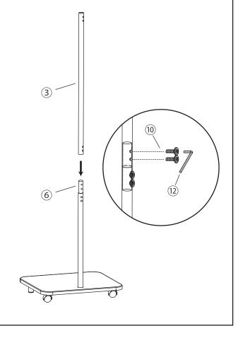
③中支柱に、⑤サイドフックを差し込み、⑨ノブボルトで固定します。 ⑤ サイドフックは、中支柱の範囲内で お好みの位置に調整が可能です。 (3) 6 ③ 中支柱に、⑥ ジョイントパーツを差し込み穴位置を合わし、⑩ ボルトと⑫ 六角レンチで ② 上支柱を、⑥ ジョイントパーツに差し込み穴位置を合わし、⑩ ボルトと⑫ 六角レンチで 取り付ける。 取り付けて完成です。 (10) 2 6 3
